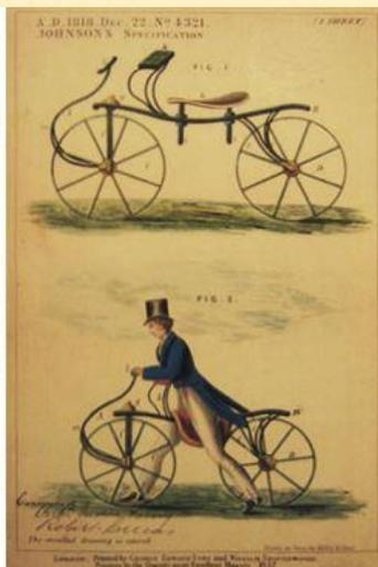
В 1817 году барон Карл фон Дрез, который служил лесничим и часто на лошади объезжал большие территории, изготовил деревянную машину. Она представляла собой конструкцию, состоящую из двух колёс, которые соединялись рамой с седлом и рулём. Двигалась такая машина за счёт отталкивания ногами от земли. И называлась она «машина для бега».
